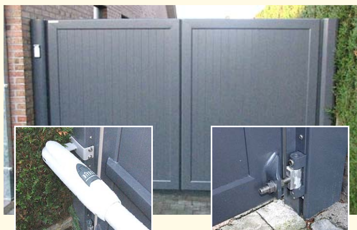
De scharnieren zijn volledig in aluminium ingeclipst in de poortpaal en verdoken en inbraakwerend bevestigd. Op dezelfde wijze gebeurt de bevestiging van de motoren en de afregeling conform EN 13241-1 ivm de CE-markering op deze poorten
