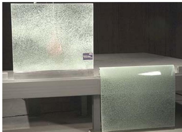
Vergelijking van een schokproef op glas met een SGP folie t.o.v. een PVB-folie (rechts)
