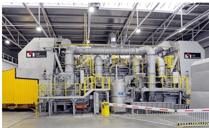
Een twee-kamer oven is in staat om gelakt en polymeer-bevattend schroot te verwerken
